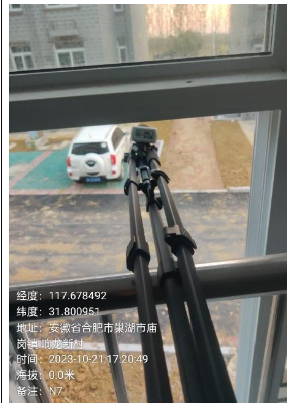
N7: 17#住宅楼 204 窗外 1m
